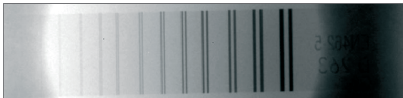
300 kV, 35 Watt Targetleistung, 40 mm Stahl, D9 Drähte ortsaufgelöst, D12 sichtbar
