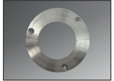
Skala zur Bestimmung der Drehposition des Targets.
